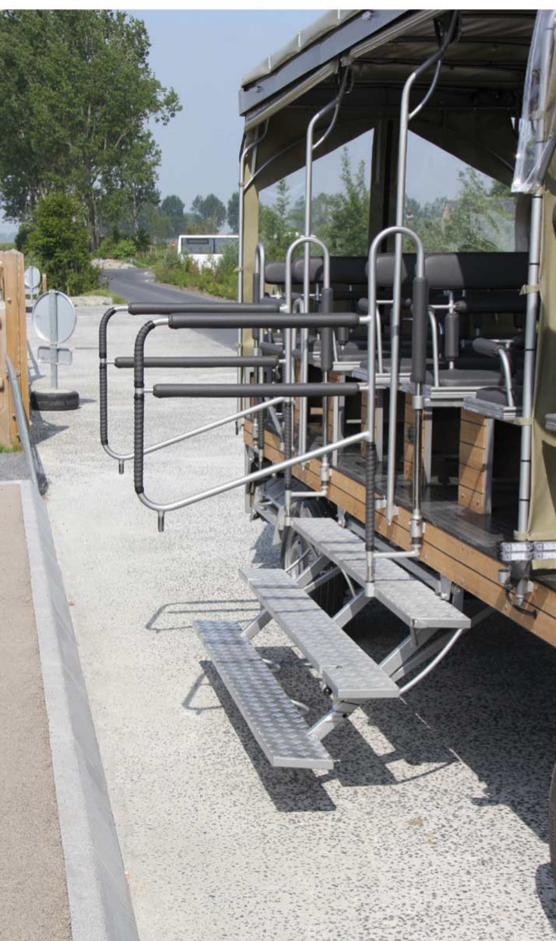
Un ensemble de détails pour assurer le confort et la sécurité des passagers, cochers et chevaux. (Jeu de marchepieds rétractables, toit ouvrant, ressort de traction, rampe d'accès pour fauteuil...)
